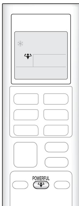
Le fonctionnement PUISSANT maximise rapidement l'effet de refroidissement (chauffage) dans n'importe quel mode de fonctionnement. Dans ce mode, le climatiseur fonctionne à sa capacité maximale.
